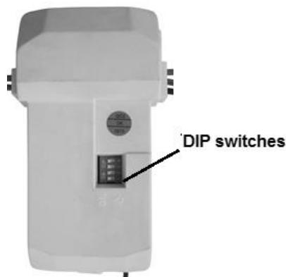
**Fig. 10 Interruttore DIP ricevitore**
