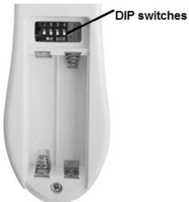
**Fig. 9 Compartimiento de las baterías del control remoto receptor**
