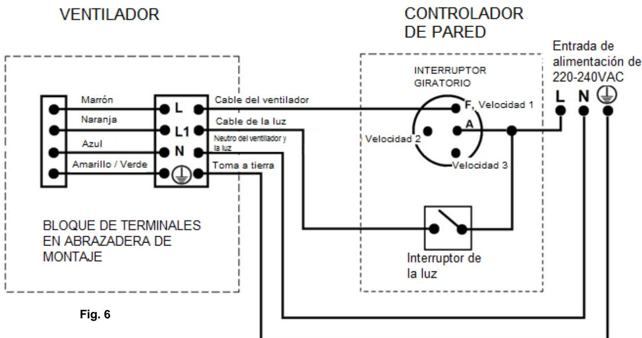
**USO CON UN DIAGRAMA DE CABLEADO DE UN MANDO A DISTANCIA: (EL MANDO A DISTANCIA se vende por separado)**
