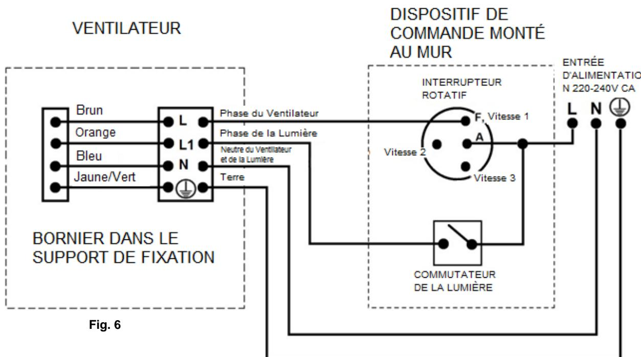
**UTILISER AVEC LE SCHÉMA DE CÂBLAGE À DISTANCE: (DISPOSITIF À DE CÂBLAGE À DISTANCE vendu séparément)**
